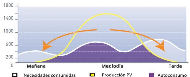
Funcionamiento con descarga de baterías. La potencia sobrante se almacena para consumirla después
