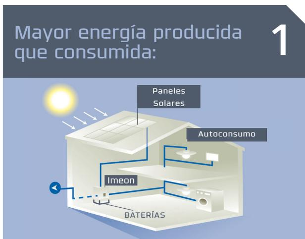
La energía solar cubre las necesidades del consumo y carga las baterías simultáneamente. El excedente eventual de la energía solar se inyecta a la red.
