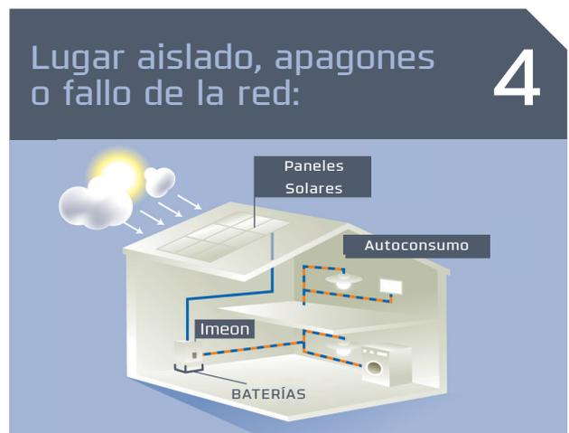
La instalación solar cubre las necesidades de consumo y carga de baterías. Las baterías proporcionan la potencia complementaria si así es necesario.
