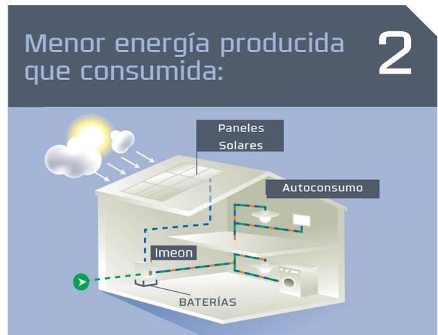
La energía solar cubre una parte de las necesidades del consumo. Las baterías y la red eléctrica proporcionan la potencia restante necesaria.
